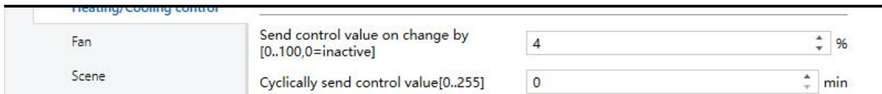
Parameter setting of “Continuous control(use PI control)” (2) Fig.5.5.2.1.2(1) “Heating/Cooling control” parameter window
