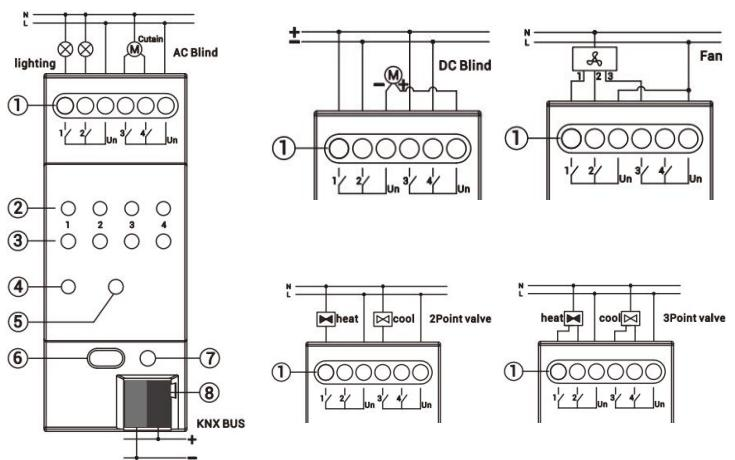
**① Ausgänge, Lastanschluss:** Das abgebildete Symbol zeigt das Schaltprinzip für jeden Kanal an.
