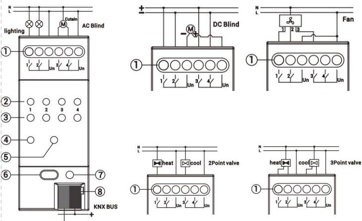
① Bornes Sorties: les icônes ci-dessus indiquent la méthode de câblage pour chaque sortie.
