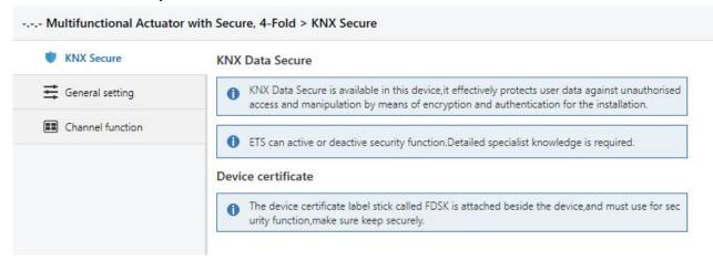
Fig.5.1 (1) "KNX Secure" parameter window
